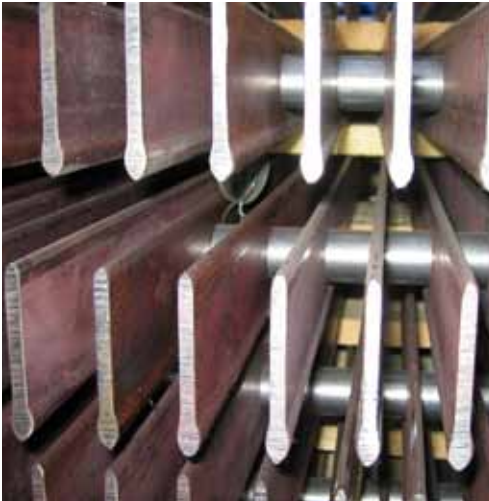
Abb. 3: Neue Rechenprofile mit optimiertem Strömungsverhalten
